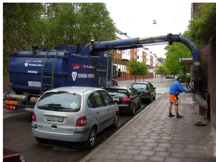
Tømming av Eleikos mobile system med standard søppelsugebil.
